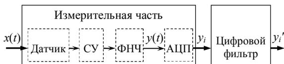
Рисунок 1 – Функциональная схема входной части СБИ
