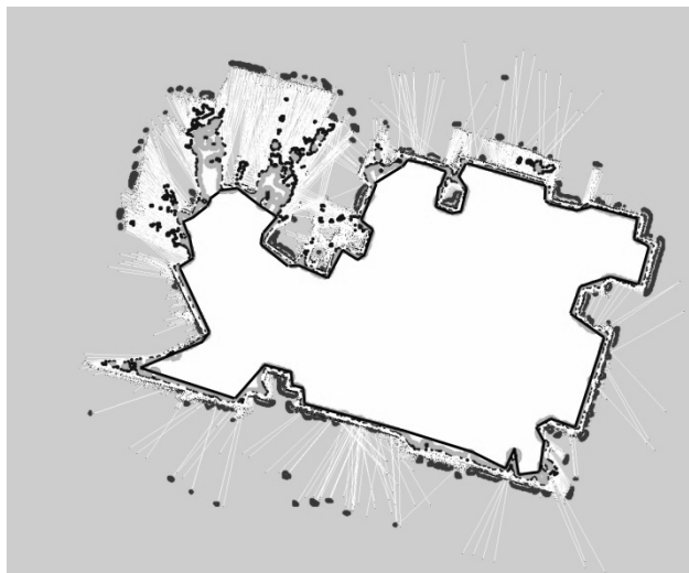
Рисунок 7 – Карта проходимости с векторизованным контуром (показан жирной чёрной ломаной линией)
