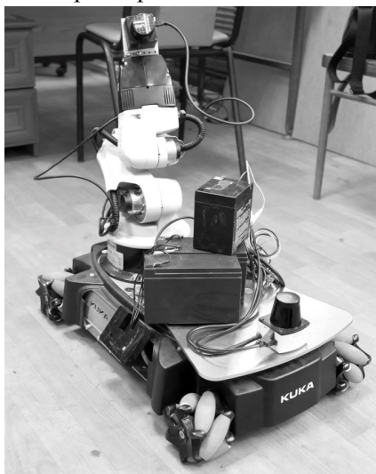
Рисунок 4 – МРП с установленными лазерными сканерами
