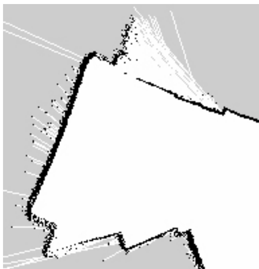
Рисунок 2 – Пример карты проходимости, полученной с помощью лазерного сканера с двумерной диаграммой направленности
