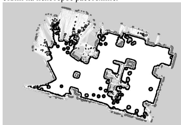
Рисунок 6 – Карта проходимости с отмеченными границами коридора проходимости (выделены жирной чёрной линией)
