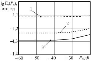
Рисунок 2 — Логарифмические зависимости длины вектора невязки от мощности шума
