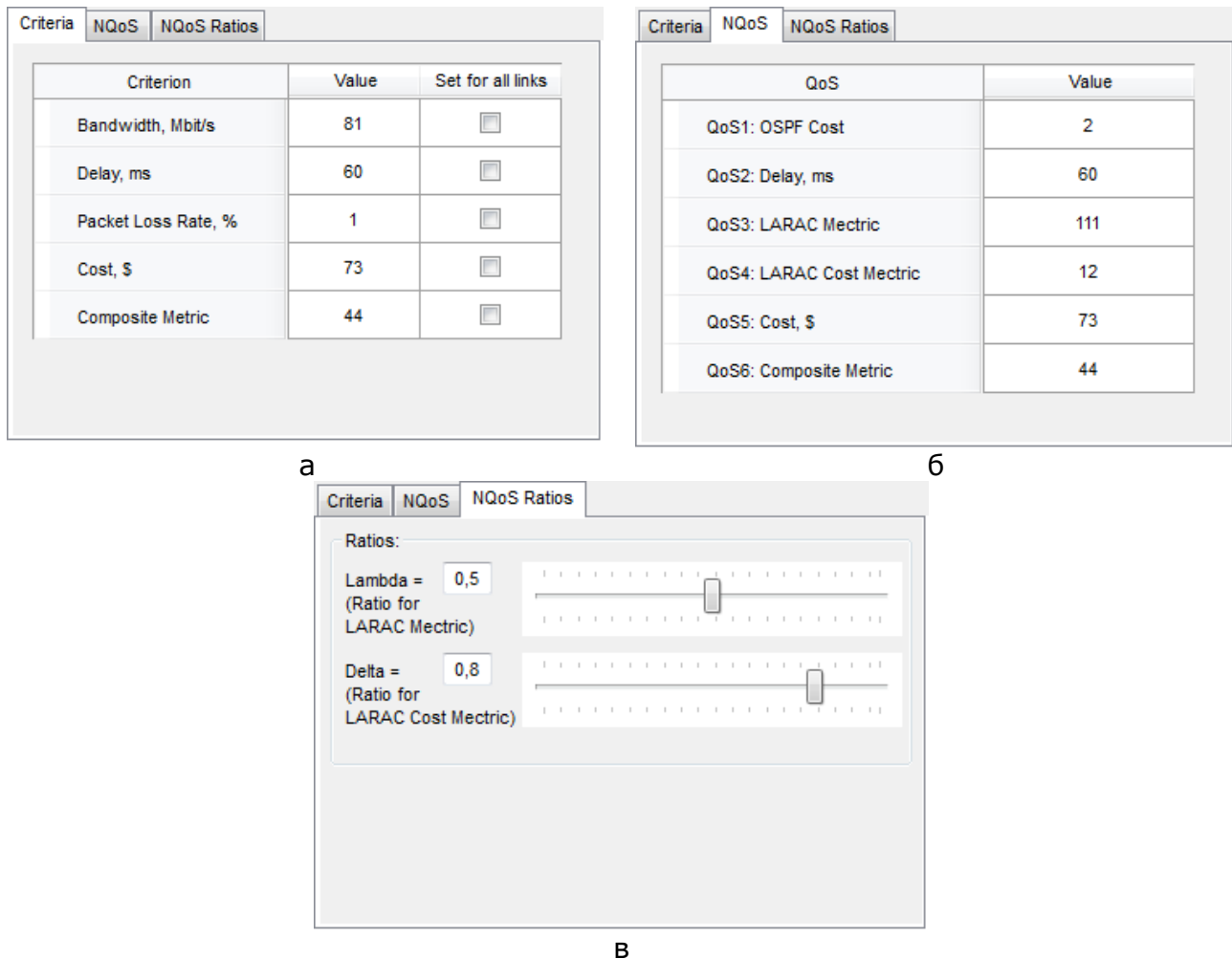
Рис. 3 – Значения параметров и метрики качества сервиса произвольного канала связи: а – значение критерия качества; б – значение QoS-метрик; в – значение коэффициентов для метрик QoS 3 и QoS 4
